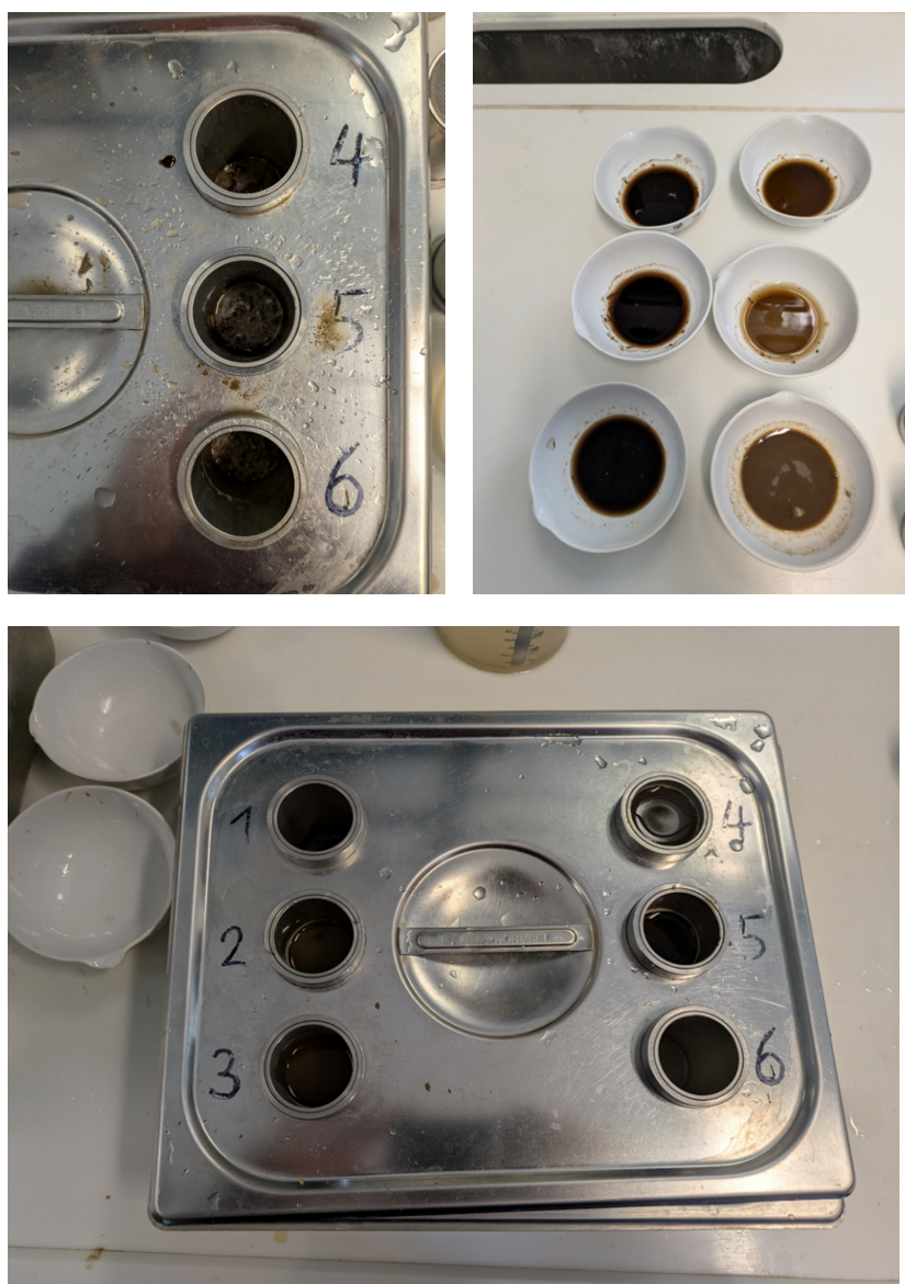
obr. 5.-7. měření stability půdních agregátů
